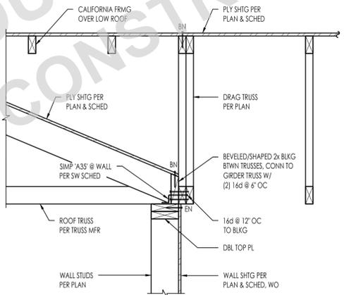
TRUSS TO GIRDER TRUSS W/ WALL BELOW
