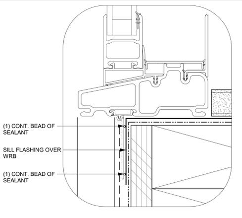
**13 DETAILED SILL FLASHING**
