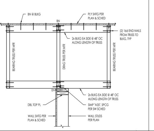
ROOF TRUSS PERP TO GIRDER TRUSS
