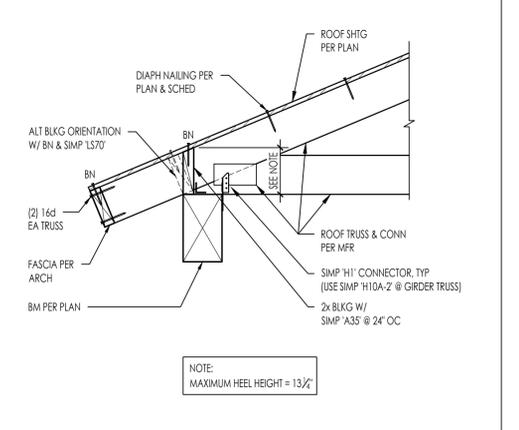
ROOF TRUSS PERP TO GIRDER TRUSS
