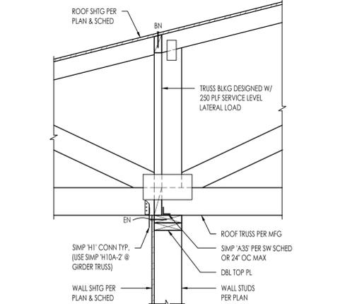
TRUSS TO GIRDER TRUSS W/ WALL BELOW
