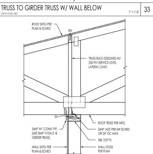
TRUSS TO GIRDER TRUSS W/ WALL BELOW
