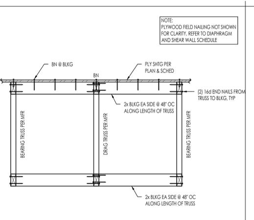
ROOF TRUSS PERP TO GIRDER TRUSS
